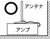
機器や金属物の周辺にループアンテナを設置しますと感度が低下します。
